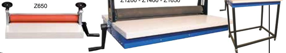
Zum Kaschieren eines Fotos geht man folgendermassen vor: Man schneidet ein Stück Film zu (etwas grösser als das Foto, das man kaschieren will) und legt es auf dem Foto. Das Ganze wird durch die zwei Walzen eingeführt, die mit einem Griff zum Drehen gebracht werden. Der Druck der Walzen lässt den Film am Foto haften.
